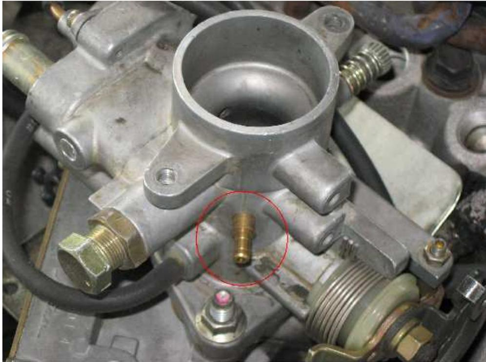
**Figura 4:** Mezcladoras Aisan – Localización del Puerto de aire al vacío
